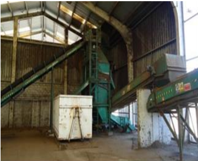
3. Mesa densimétrica de la planta de afino
