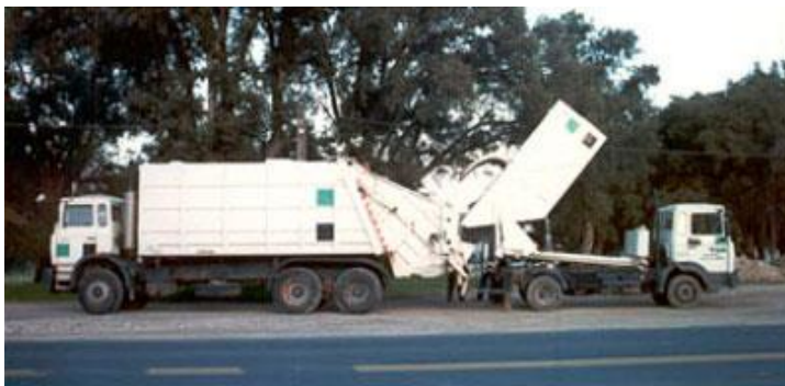
Ilustración 3. Transferencia de residuos domésticos de camión de recogida (satélite) a camión recolector-compactor de gran capacidad (nodriza), para su transporte a la planta de tratamiento de residuos.
