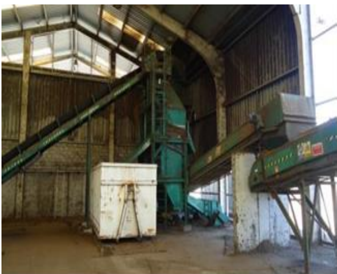
3. Mesa densimétrica de la planta de afino.
